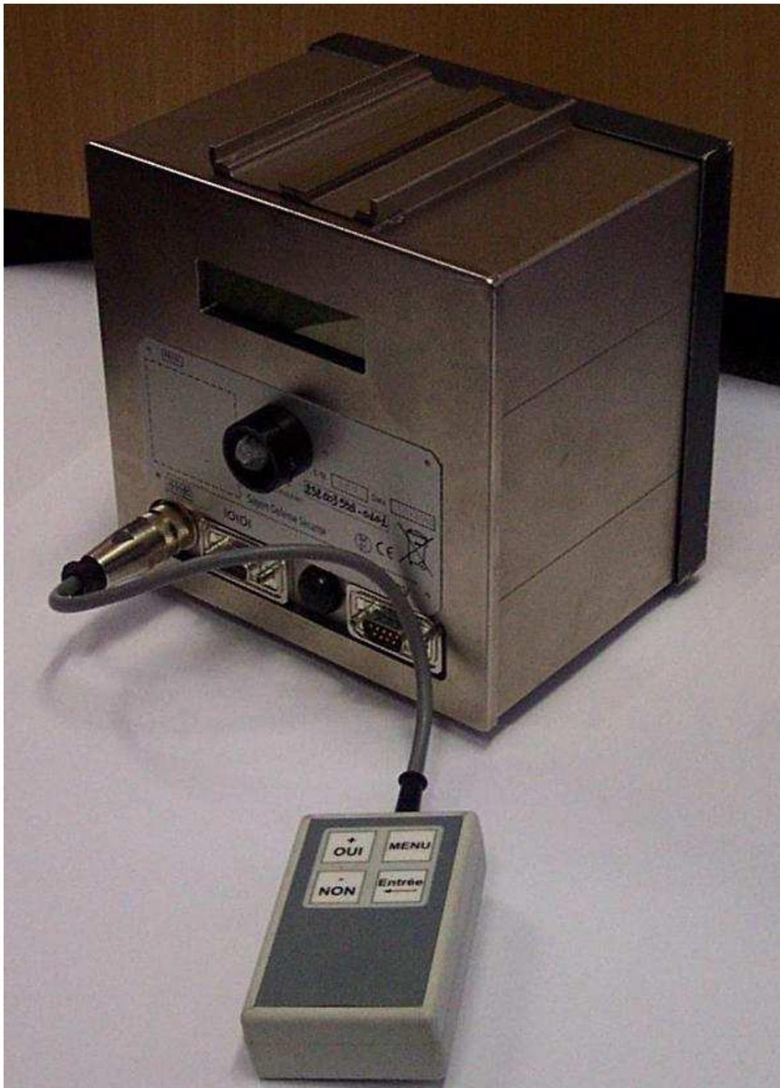
Face arrière du cinémomètre Sagem DS type MESTA 210 C muni du clavier de commande
